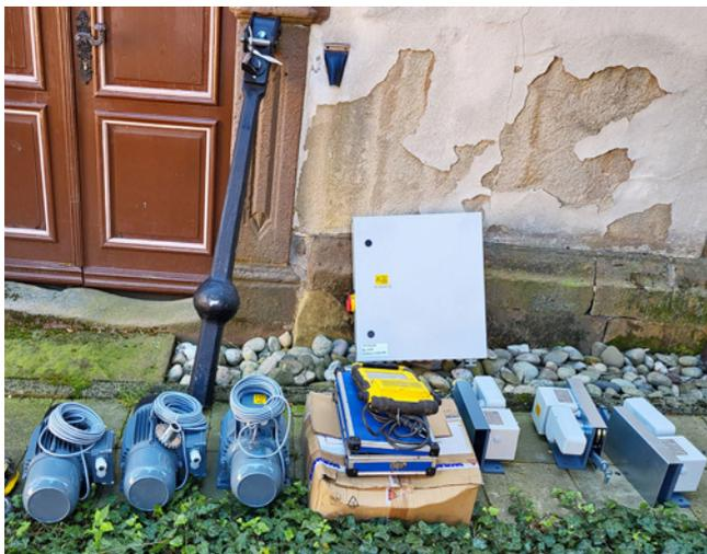
Im Herbst 2023 erteilte das Prebyterium nach Rücksprache mit der Glockensachverständigen Frau Müller der Firma Hörz den Auftrag für eine neue Läuteanlage, die alle drei Glockensteuerungen umfasste. Aus statischen Gründen durften die drei neuen Antriebsmotoren nicht mehr im Turmgebälk, sondern in der Stahlkonstruktion der Glockenstuhls verbaut werden, was einen hohen Aufwand erfordern sollte.
