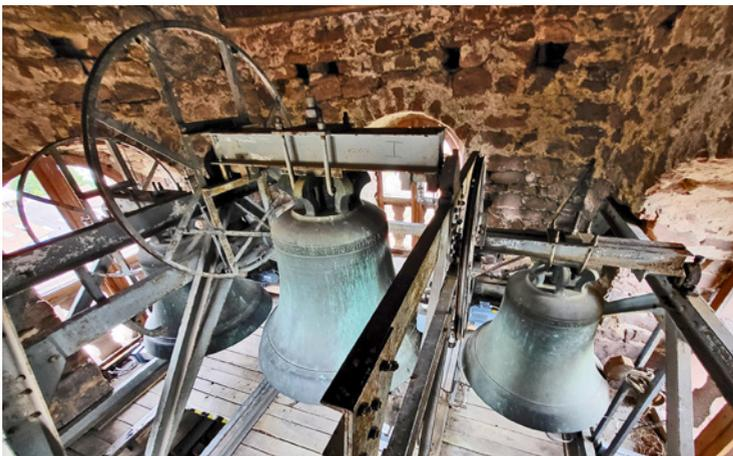
der Klöppel und der Austausch der gesamten Läuteanlage. Für den Transport der neuen Teile und des Montagewerkzeugs durch die engen und verwinkelten Turmtreppen in die Glockenstube wurde ein halber Tag benötigt. (Ein Klöppel wiegt ca. 80 kg!). Allein der Umbau der vorhandenen Antriebsräder für die Motoren verschlang einen ganzen Tag Montagezeit. Trotz schweißtreibender Temperaturen um 30 Grad konnte die neue Steuerung dann am 27. Juni in Betrieb genommen werden.
